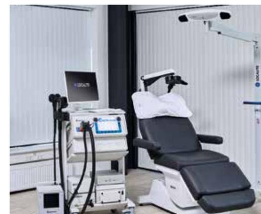
La solution Axilum Robotics Cobot assure le contrôle des mouvements et un niveau élevé de répétabilité et de précision entre les sessions de SMT. Elle est particulièrement adaptée à la recherche et fonctionne avec les stimulateurs et bobines MagVenture. Elle peut être pilotée par un système de neuronavigation de Localite (guidage IRM).
